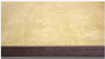
Столешница из фанеры 40 мм, покрытая бесцветным лаком (Ф)
