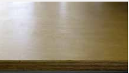
Столешница из фанеры 24 мм, покрытая бесцветным лаком (Ф).
